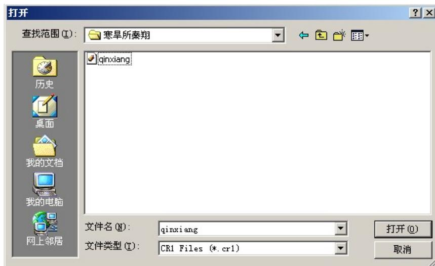
找到 PC 机里存放的编译过的\*.CR1 件（CR1000 集器），点击打开，弹出一个警告对话框(提示发送程序采集器中的数据将丢失)，点击确定，开始发送程序。
