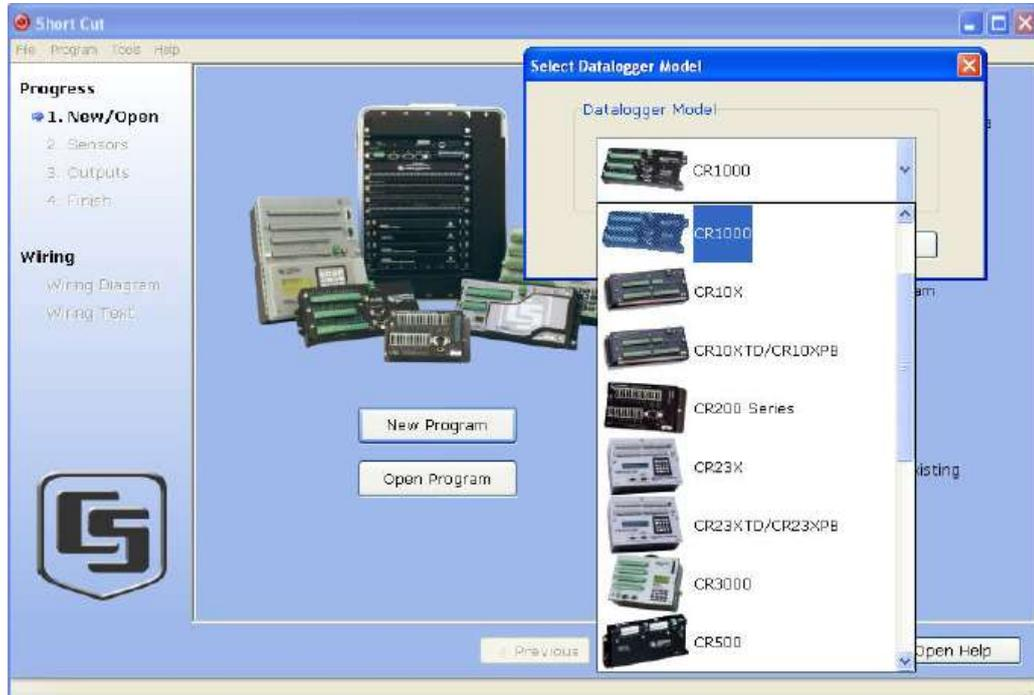
选择扫描频率，越高的扫描的频率会导致更高的功耗，一般情况下，使用 5-15 秒间隔扫描，该频率是扫描频率不是存储频率，存储频率会在后面选择。
